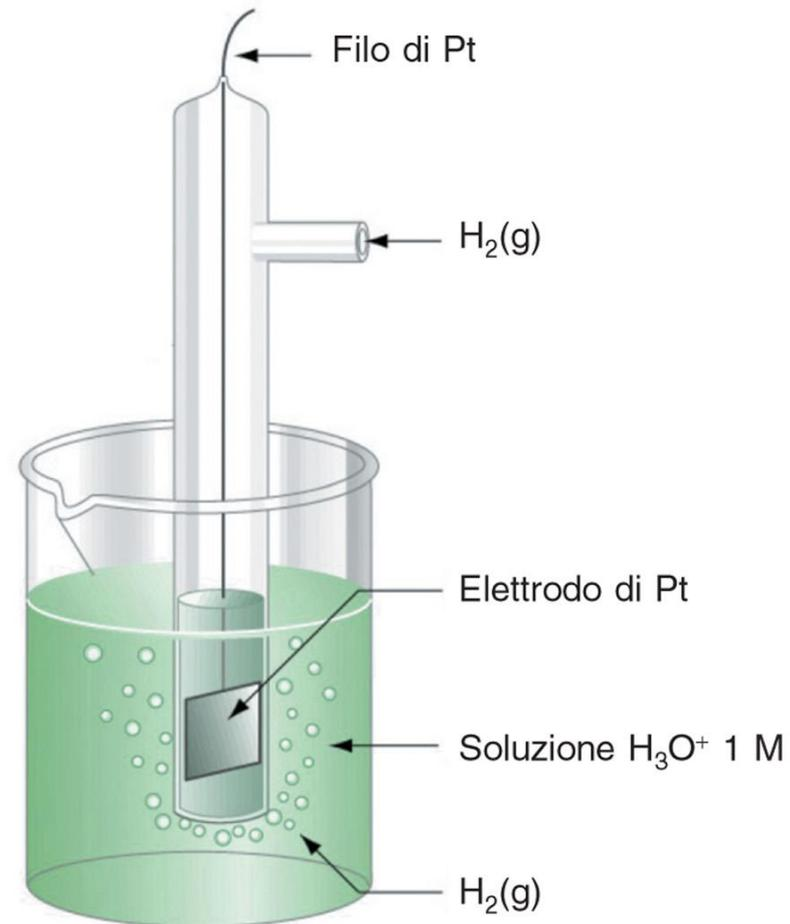
Avendo a disposizione l'elettrodo di riferimento, è possibile determinare il potenziale dei vari semielementi.
