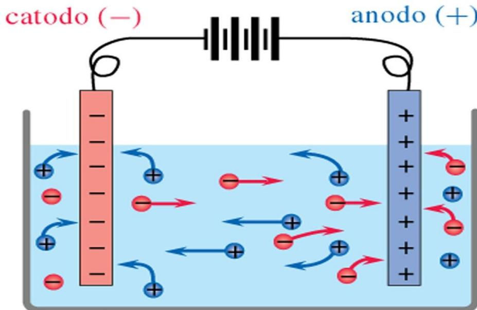
consideriamo il processo di elettrolisi del cloruro di sodio
